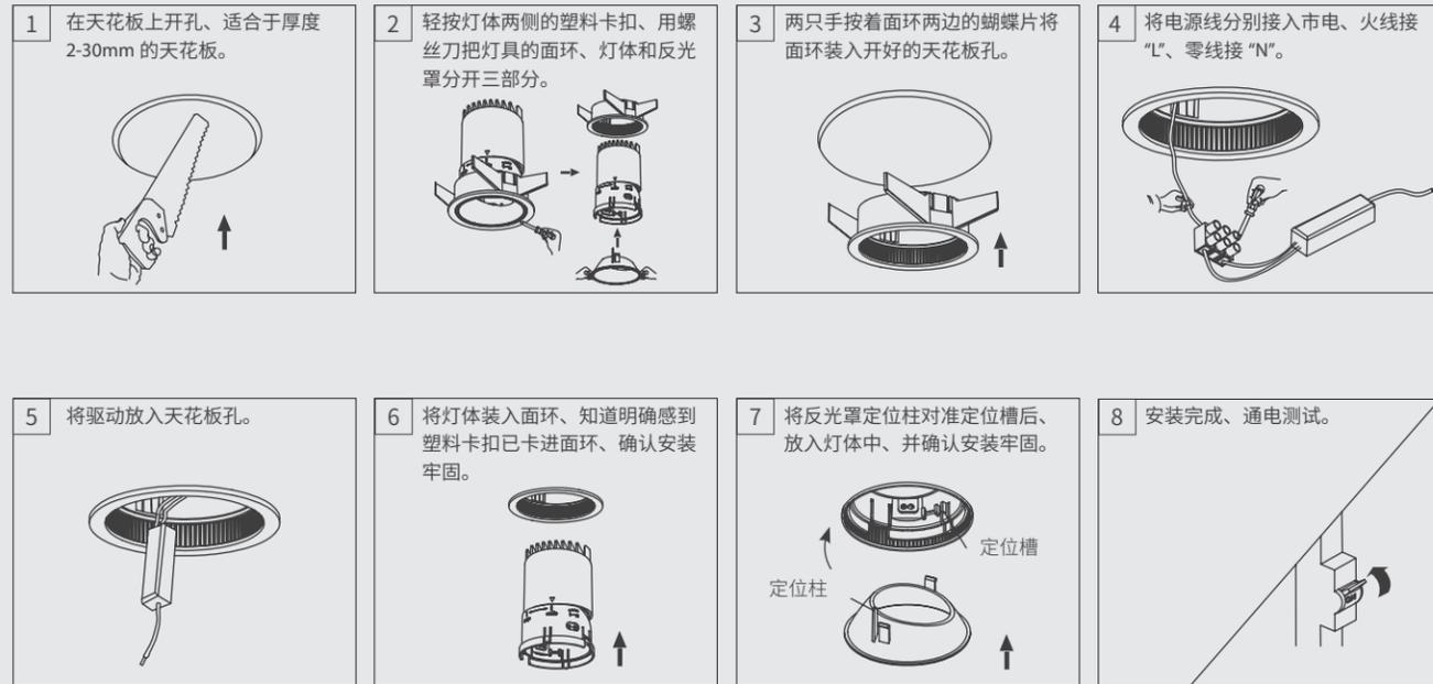
安装方法二（适用于开孔尺寸  $\Phi 50\text{mm}$ 、 $\Phi 75\text{mm}$ ）：
